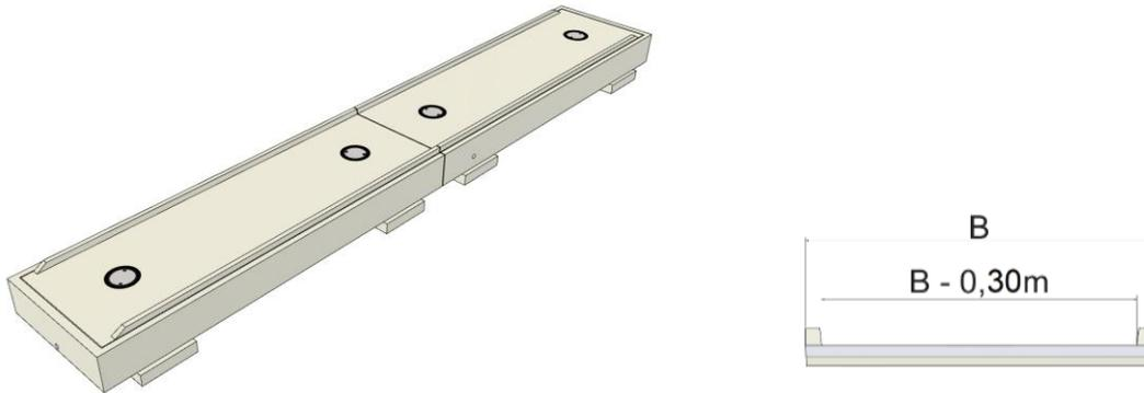
Aufkantung aus Beton an beiden Längsseiten der Waagenbrücke zur seitlichen Absicherung der korrekten Fahrzeugposition auf der Waage.
